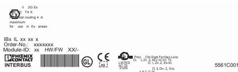
Рисунок 2-4 Пример маркировки модуля допущенного для использования в Зоне 2
